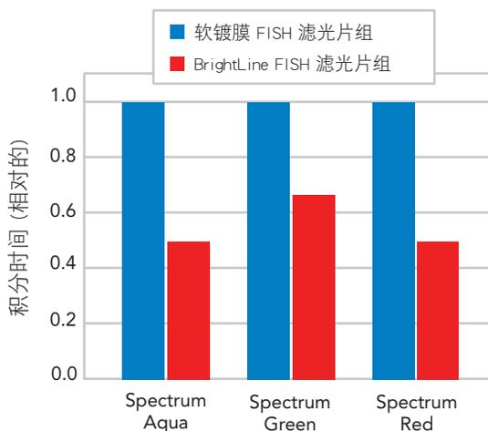
适用于查找中期分裂相等自动化任务。这个独立的行业测试比较了 BrightLine FISH 滤光片组和软镀膜滤光片组所需的积分时间。该自动化系统基于蔡司 AXIO 成像显微镜, 使用相同的图像强度来找到中期分裂。BrightLine FISH 滤光片组的积分时间更短, 成像速度更快。
