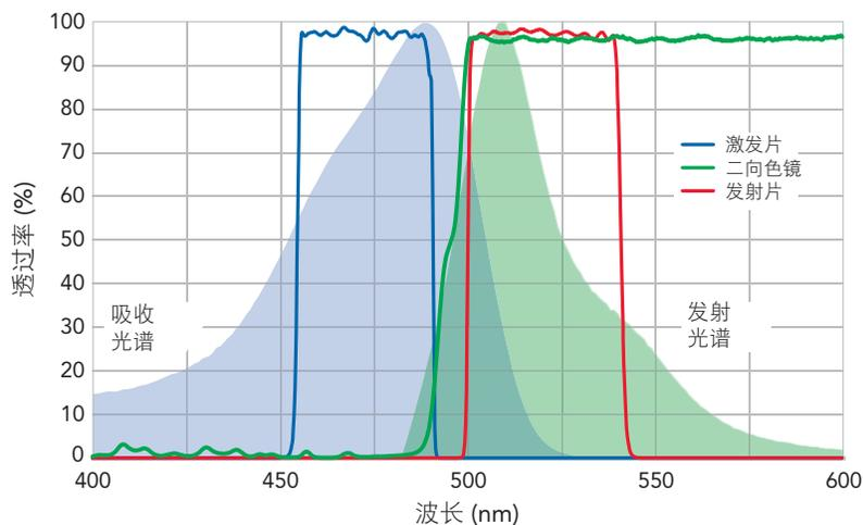
左图展示了应用于绿色荧光蛋白 GFP 的 GFP-3035D 滤光片组的光谱实际测量曲线。我们的产品结合了硬镀膜工艺与单基结构，可获得 >90% 的高透过率和陡峭的边缘。
