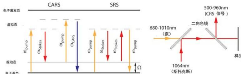
在 CRS 中，使用两个激光来激发样品。第一激光器的波长（通常是固定波长，1064nm 激光器）设置为斯托克斯频率， $w_{\text{Stokes}}$ ，第二激光器的波长被调整到泵频率， $w_{\text{pump}}$ ，在这两个激光器之间，匹配一个固有的分子振动，频率均为  $w_{\text{pump}} - w_{\text{Stokes}}$ ，在样品中生成 CARS 和 SRS 信号。
