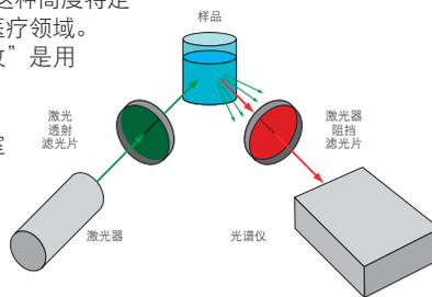
光学滤光片是拉曼光谱系统中的关键元件，它可以防止所有不必要的光到达光谱仪，这些不必要的光会淹没相对较弱的拉曼信号。安装在激光器和样品之间的激光透射滤光片用于阻止来自激光器的所有不必要的光（如宽带自发辐射或等离子体线）、以及激光器和样品之间产生的任何拉曼散射或荧光（如在光纤微探针系统中）。在样品和分光计之间插入的激光阻挡滤光片在激光波长处阻挡瑞利（弹性）散射光。
