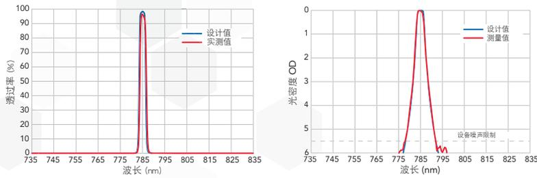
这些图表显示了785纳米Maxline激光滤光片的卓越性能，激光线上的透过率保证超过90%，距离激光线小于1%处的阻挡保证OD>5。注意与设计曲线的良好一致性。
