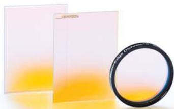
Semrock的RazorEdge二向色镜分束镜展示了很好的性能。每个滤光片在45度入射角时反射标准的激光线，同时有效的透过更长的拉曼位移波长。这些滤光片展示了从反射到透射的很陡的过渡。U级别的滤光片保证的过渡宽度为 < 1%的激光波长（不考虑偏振）。上述性能是我公司流行的常规入射角的RazorEdge长波通滤光片的推荐搭配。
