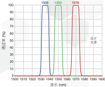
Semrock 的离子束溅射工艺现在可用于制造具有精确光谱特征（锐边、通带等）的近红外波长滤光片。这些特性可覆盖约1700纳米，并且对波长的高透过率可达到 >2000 nm。本页上的带通滤光片是很好的激光源消杂和检测滤光片，它们透过特定的激光波长，并在整个InGaAs探测器范围（850–1750 nm）内几乎消除背景噪声。它们针对流行的“视网膜安全”激光器进行了优化，波长范围为1.5μm，在此处，允许的眼睛暴露的最大值比可见光或1.06μm钕激光高很多。应用包括激光雷达、遥感、测距和激光诱导击穿光谱（LIBS）。
