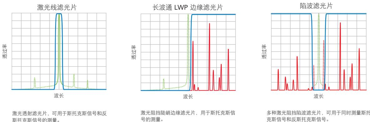
激光透射滤光片是激光透过滤光片的理想选择，陷波滤波器是激光阻挡滤光片的明显选择。在使用这两种滤光片的系统中，斯托克斯拉曼散射和反斯托克斯拉曼散射都可同时测量。然而，在许多情况下，截止滤光片（又称边缘滤光片）可更好的替代掉陷波滤光片。例如，用作测量斯托克斯散射的激光阻挡滤光片的长波通（LWP）截止滤光片提供了更好的传输、更高的激光线阻挡和更陡的边缘性能，以查看非常接近激光线的拉曼信号。有关在截止滤光片和陷波滤光片之间选择的更多详细信息，请参见第97页的技术说明“边缘截止滤光片与拉曼仪器的陷波滤光片”。
