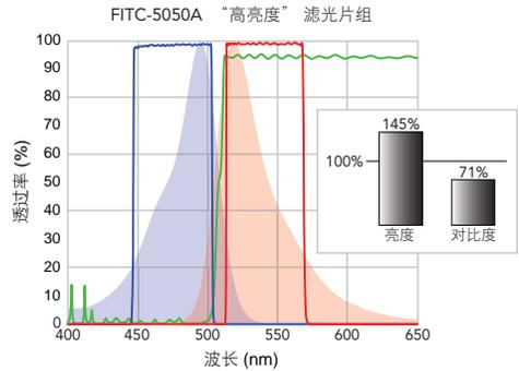
对于多种荧光染料标记的样品成像来说，首选更窄的带通滤光片组。这样的滤光片组能显著减少多个荧光染料之间的串色。狭窄的通带只允许透过荧光发射光谱中最强的部分。对于具有自发荧光的背景噪声高的样品，可以显著降低样品的自发荧光，从而提高信噪比。高对比度的滤光片组适合用于荧光信号强的样品。
