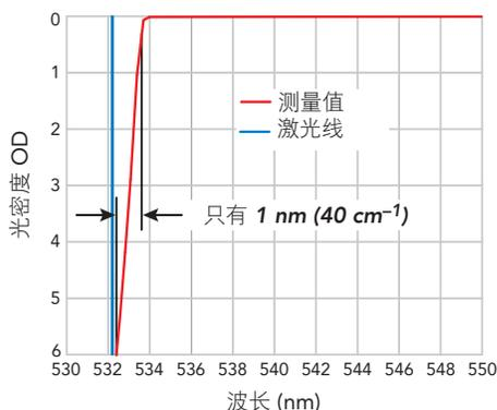
U-级别滤光片的光谱反应定位在下图的红线和蓝线间。
