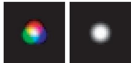
由传统滤光片组产生的合成图像（如上左图所示）通常具有显著的像素位移，是失真的，而 BrightLine -ZERO 零像素位移滤光片组（上右图）产生精确的多色图像。
