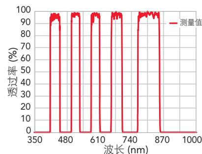
上图显示滤光片 FF01-432/515/595/681/809 的典型测量光谱
