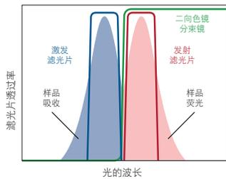
我们可以通过选择适当的光学滤光片，组成一个滤光片组，用于观察荧光或者对荧光进行成像，这样就可以达到使一个给定的荧光染料可视化的目的。您可以查看本书的第 10-13 页，我们列出了常用荧光染料表和相应推荐的滤光片组，可用于对这些荧光染料成像。因为不同荧光染料的激发光谱和发射光谱不同，滤光片组需要优化，才可以用于不同荧光染料的同时成像。在不同的实验条件下使用同一个荧光染料时，滤光片组也需要优化。
