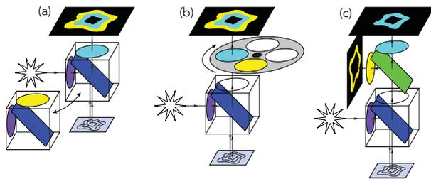
然而, 最苛刻的 FRET 应用, 如活细胞成像和单分子成像, 可能需要对供体和受体的发射信号进行“同时”成像。图 (c) 显示了同时成像的配置, 其中, 放置在显微镜发射通道中的图像分离二向色镜 (见第64页) 用于分离来自供体和受体的信号, 并将其引导至两个不同的 CCD 相机或同一个 CCD 相机的两个不同区域。由于没有运动部件, 该配置消除了基于运动的成像伪影。
