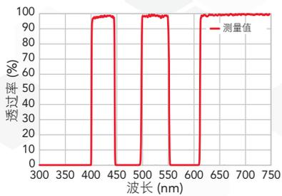
Semrock 提供多种高性能的多带荧光带通滤光片，已针对各种荧光仪器进行了优化。这些滤光片均采用我们的单一基板、低自荧光玻璃结构。所有滤光片均安装在标准的 25 mm 圆形黑色氧化铝环内，厚度如图所示，透光孔径至少为 21 mm。这些滤光片具有高的透过率、陡峭且清晰的边缘以及通带之间的性能优越的阻挡。
