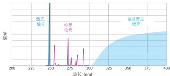
越来越多的紧凑型、价格合理的高功率紫外激光器已被广泛使用，例如266纳米的四倍二极管泵浦Nd:YAG激光器和248.6纳米的NECU空心阴极金属离子激光器，使超灵敏紫外拉曼光谱成为一种现在广泛使用的技术。
