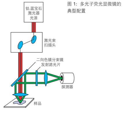
图 1: 多光子荧光显微镜的典型配置
