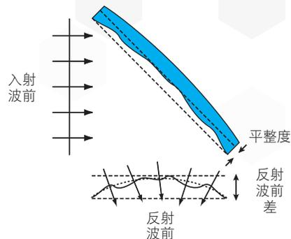
图[1]: 当光以一定角度向上照射到一个二向色镜分束镜上时，平整度的偏离会导致反射波前的畸变。
