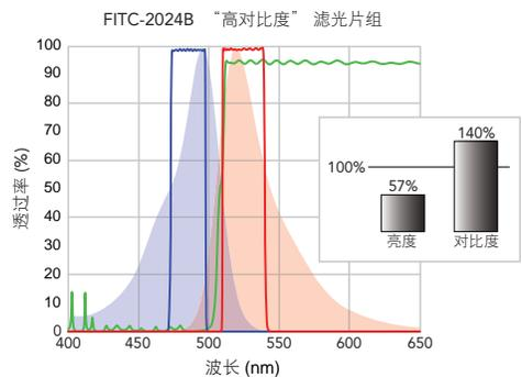
在大多数的荧光仪器中，使用薄膜干涉滤光片可获得更好的性能，薄膜干涉滤光片由多个交替的、不同折射率的、透明材料组成的薄层附着在玻璃基板上构成。滤光片复杂的层状结构决定了透过的光谱。薄膜滤光片使用简单，价格便宜，可提供很好的光学性能。例如：可通过任意确定的透过带宽、具有陡峭的边缘、和对不想要的光可实现波长范围内的高阻挡。
