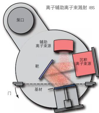
溅射工艺的一个明显局限性是光通量 - 高光通量的优良性能是以缓慢的沉积速度和有限的镀膜面积为代价的。对于磁盘驱动器头和电信滤光片的应用，尺寸最多只有一到几毫米，这种限制并不太严重。然而，它被认为是成本的一个阻碍。尤其体现在高效生产更大体积的滤光片上。Semrock 突破了这一限制，将溅射技术转变为真正的大批量生产平台。可生产大尺寸（数英寸的）的非常多的层数的光学滤光片。我们在不影响溅射的优良光学性能的情况下完成了这项工作，因为具有极高光学厚度精度的致密、低散射的薄膜层是由溅射制造完成的。Semrock 在工艺技术方面取得了突破性的进展，也提高了速度和均匀性，我们甚至在今天仍在不断地改进工艺。我们的沉积技术拥有专门的硬件、算法和软件，可构成实时的 Semrock “光学监控” 系统，基于该系统的沉积技术能够重复沉积数百个甚至任意厚度的薄膜层，可生产制造出具有卓越光谱特性的复杂滤光片。
